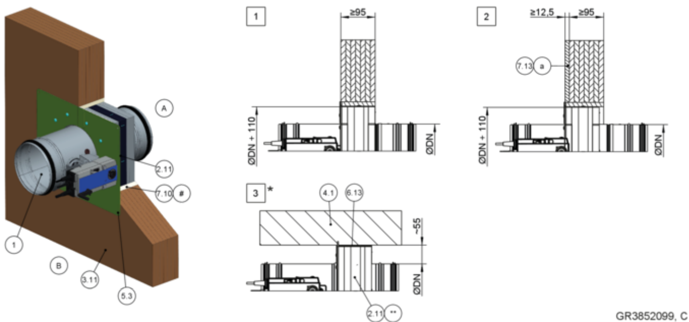
Afb. 126: Droge inbouw met inbouwset in massief houten resp. multiplex wand met inbouwset TQ2
