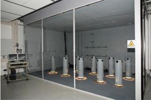
Voici une vue d'ensemble de nos installations d'essais pour la technologie de diffusion d'air dans les pièces. En principe, les installations citées ci-dessous sont également disposées à mesurer les systèmes air-eau.
