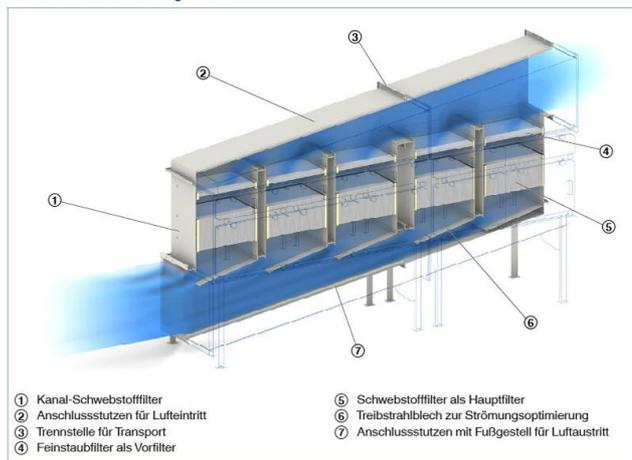
Anschlussstutzen KSFSSP zum Aufbau einer Filteranlage mit Kanal-Schwebstofffilter KSFS für hohe Anforderungen.
