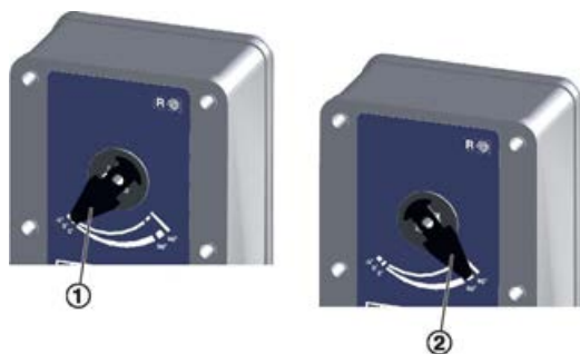
Fig. 45 : Indicateur de position de lamelle
